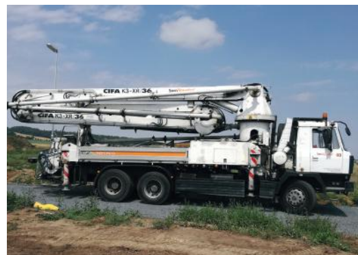
Čerpadlo betonu CIFA na podvozku Tatra 815 dosah ramene: 36 m, přídatné potrubí a hadice
